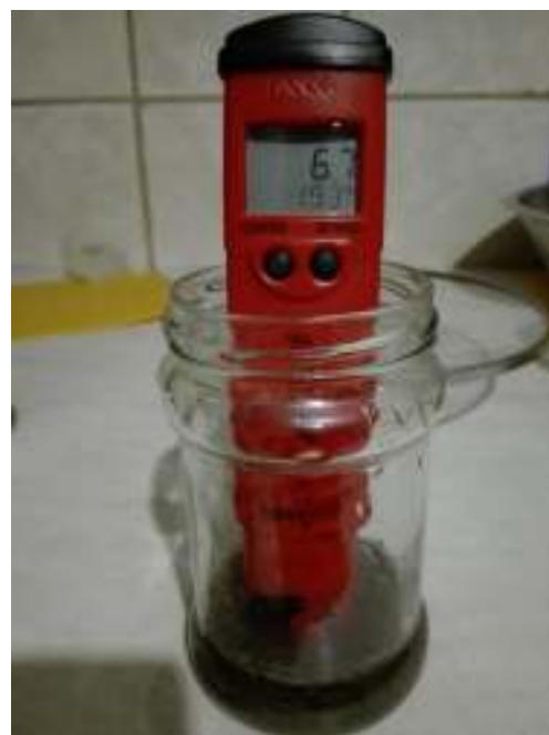
Fot. 6. Badanie próbki gleby pehametrem elektronicznym (Jakub Soja)
